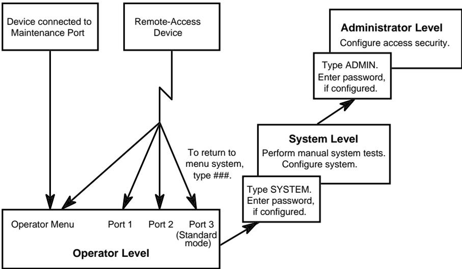
Figure 14-1. Open-Operator-Menu Mode
