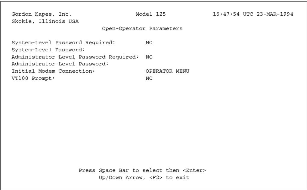
Figure 14-6. Open-Operator Parameters Screen
