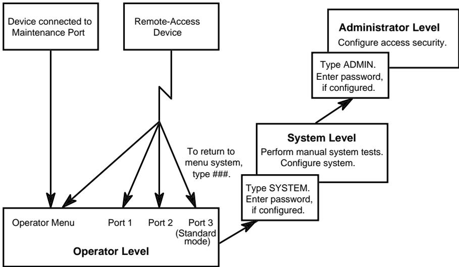
Figure 14-1. Open-Operator-Menu Mode
